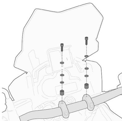
**02SKITK** Spezifisches Kit für die Montage der Smart Bar KS900A
