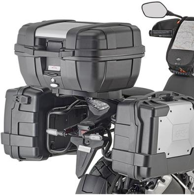
**KLO1171MK** Spezifischer Seitenkofferträger KL ONE-FIT für die Konfiguration von MONOKEY® Seitenkoffern
