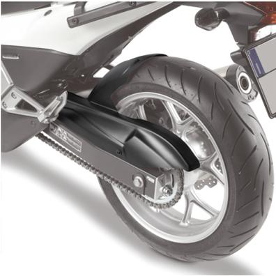
**KMG1109** Spezifische Hinterradabdeckung mit Kettenschutz aus ABS
