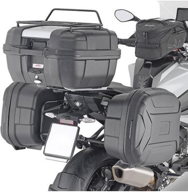
**KLO5138MK** Spezifischer Seitenkofferträger KL ONE-FIT für die Konfiguration von MONOKEY® Seitenkoffern
