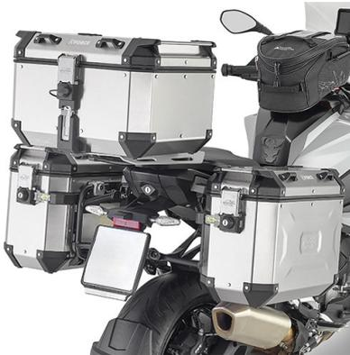
**KLO5138CAM** Spezifischer Stahlrohr-Seitenkofferträger KL ONE-FIT für die MONOKEY® CAM-SIDE-Konfiguration
